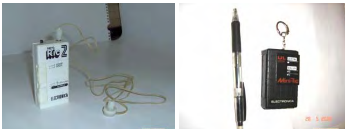
Fig II.5.2 Seria de radioreceptoare miniaturizate RIC 1 – 4 cu microcască și Mini RIC
