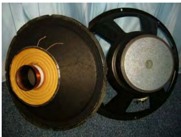
Fig II.6.1.2 Ansamblul membrană și ansamblul șasiu-magnet înainte de asamblare
