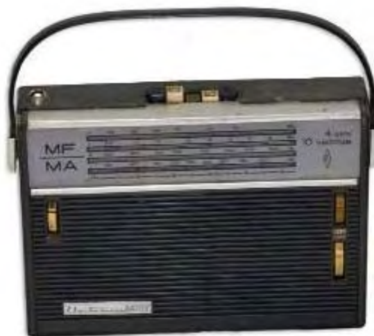
Fig.II.4.1. Mamaia S 651 T , primul radioreceptor portabil cu UL, UM, US și UUS
