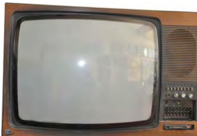
Fig. II.5.7. Cromatic 02 , cu diagonală de 67 cm, din a doua serie de televizoare color, produse cu seturi din R.D.G
