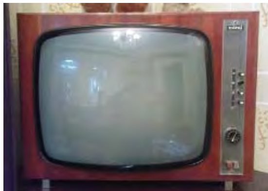
Fig.II.4.6 Miraj E59 – 681 , televizor cu tuburi electronice, de concepție românească din seria Miraj – Venus, ultima serie cu tuburi electronice
