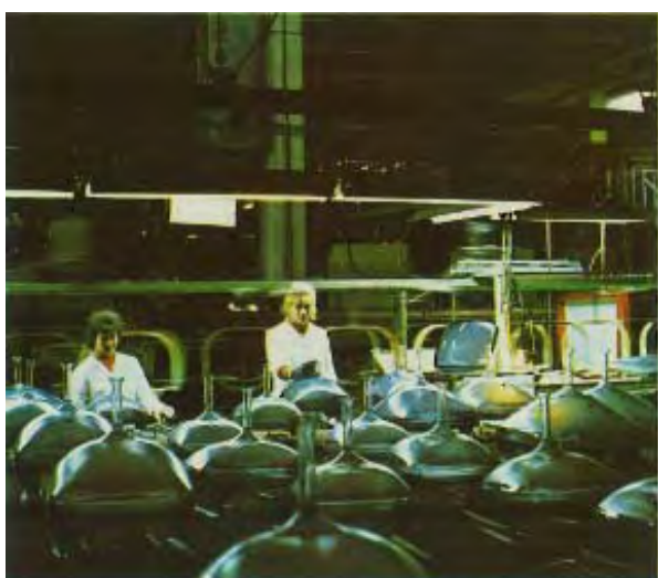
Fig. III.3.4. Standul de verificare a tuburilor cinescop
