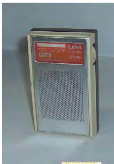
Fig.II.4.4 Cora S 711 T Primul radioreceptor miniatură de buzunar
