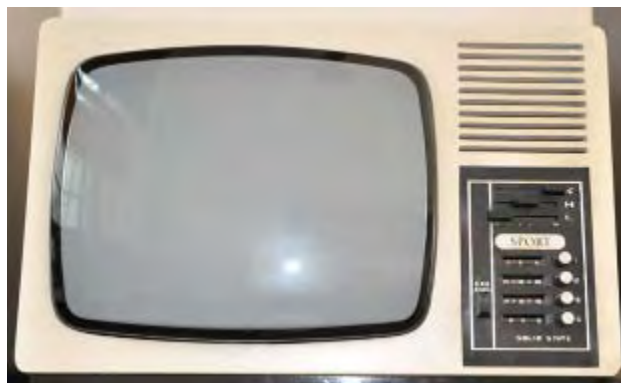
Fig II.4.7. Sport E 31 – 731 unul din tipurile de TV portabile tranzistorizate din seria Sport.
