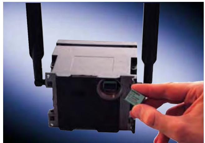
Einstecken des C-PLUG beim IWLAN Access Point SCALANCE W788-1PRO an der Geräterückseite
