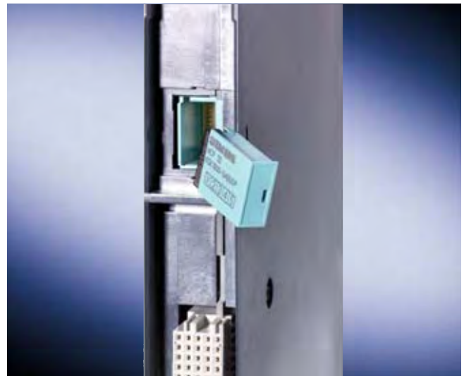
Einstecken des C-PLUG beim CP 443-1 Advanced an der Geräterückseite
