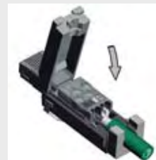
③ Kontaktierdeckel zur Kontaktierung der Adern herunterdrücken.
